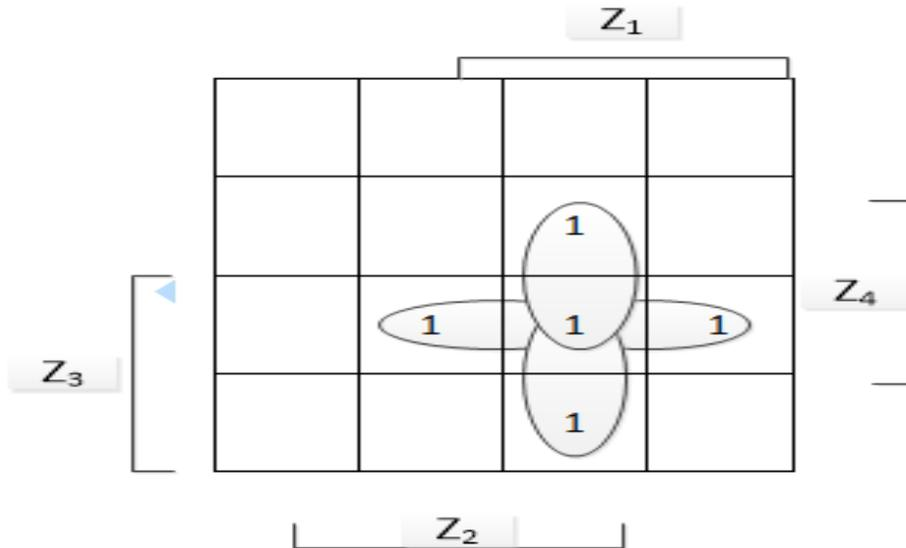
$$(a) \text{Sy}(\{3, 4\}; Z) = Z_1 Z_2 Z_3 \vee Z_1 Z_2 Z_4 \vee Z_1 Z_3 Z_4 \vee Z_2 Z_3 Z_4$$
