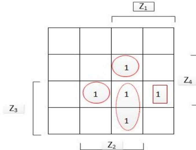
$$(b) Sy(\{3, 4\}; Z) = Z_1 Z_2 Z_3 \vee Z_1 Z_2 \bar{Z}_3 Z_4 \vee Z_1 \bar{Z}_2 Z_3 Z_4 \vee \bar{Z}_1 Z_2 Z_3 Z_4$$
